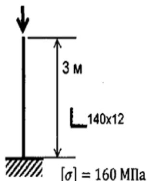
Определить критическую нагрузку для стойки
