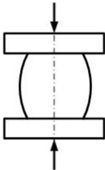
Цилиндрический образец при испытании на сжатие принимает бочкообразную форму вследствие ...
